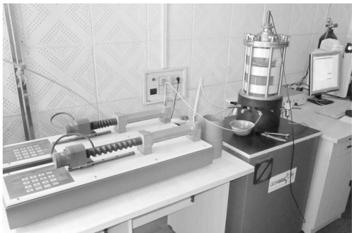
图 1 DYNTTS——电机控制的动三轴测试系统
