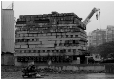
图 5 水泥块堆重-反力架装置静载试验现场图
