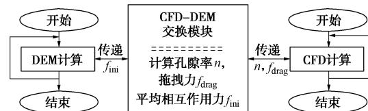
图 13 DEM-CFD 耦合流程
