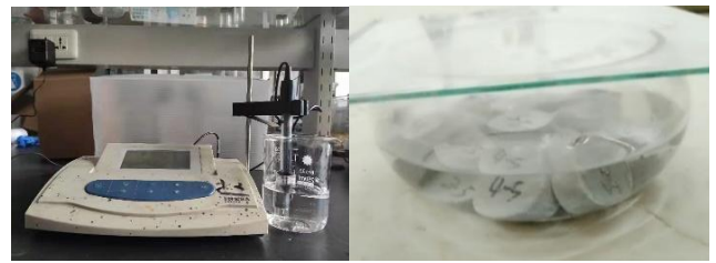
图 1 灰岩试样腐蚀过程
